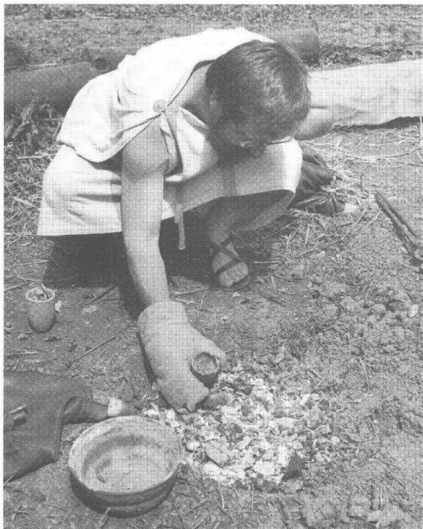
Abb. 14 Der Bronzegiesser kurz vor dem Guss – noch muss etwas Metall in den heißen Tiegel nachgefüllt werden.
