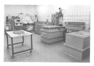
Abb. 25 Konservierungen und Ruinendienst Augst: die neue Werkstatt für Eisenrestaurierung und Galvanoplastik. Rechts Wannen für die Herstellung von Kupfergalvano-Kopien.
