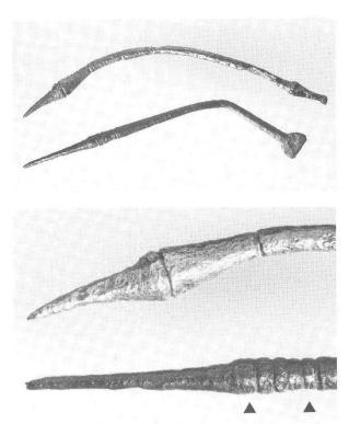
Abb. 27 Zwei weitere Beispiele unterschiedlicher Restaurierungsmethoden (Stili [Schreibgriffel] aus Eisen): Oberes Exemplar elektrolytisch entrostet, unteres Beispiel manuell präpariert. Die Detailaufnahme unten zeigt, dass bei schonender Behandlung auch Reste von Bronze- oder Messing-Tauschierungen erhalten werden (Pfeile). M. 2:3 (Detail unten 2:1).
