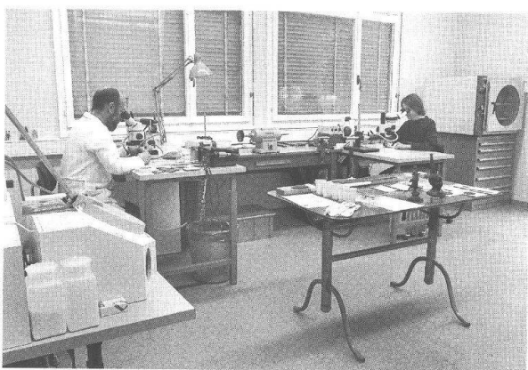
Abb. 23 Konservierungen und Ruinendienst Augst: die neu eingerichtete Werkstatt für Bronzerestaurierung. Links das Microsandstrahlgebläse, rechts ein Trockenschrank.
