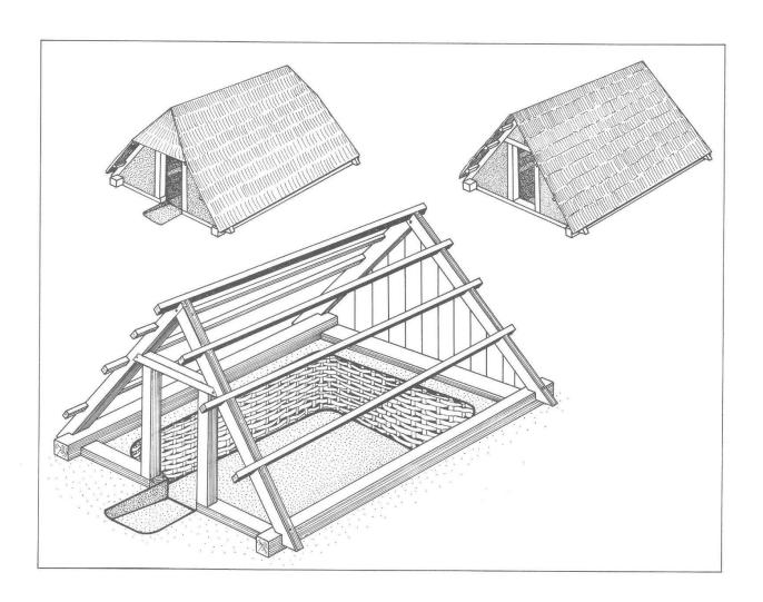
Abb. 26 Grubenhäuser mit Schwellbalken. Rekonstruktionsversuche.
