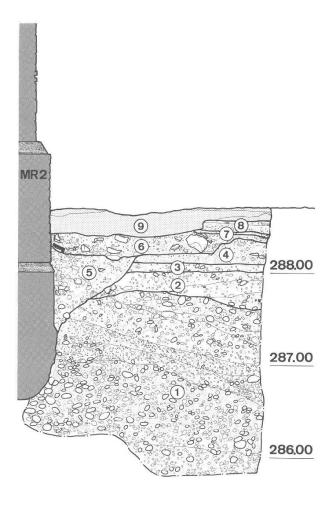
Dies zeigte sich zum Beispiel sehr deutlich in Profil 1 (Abb. 12), wo die Baugrube der jüngeren Basilika-Stützmauer (MR 2) auf der Kote 287.40 m ü. M. liegt. Andererseits zeigt die Mörtelplatte im Winkel zwischen Mauer 1 und Mauer 2 (Abb. 15), dass die Unterkante der Baugrube hier mindestens 0,6 Meter tiefer lag und auch eine grössere Ausdehnung besessen hat, als dies der Befund in Profil 1 (Abb. 12) vermuten lässt (s. auch unten).
