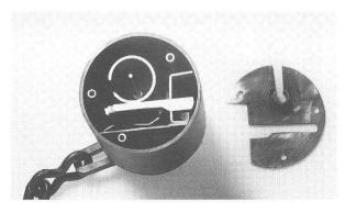
Abb. 17 Das Schloss teilweise zusammengesetzt (genietet). M. etwa 1:2.
