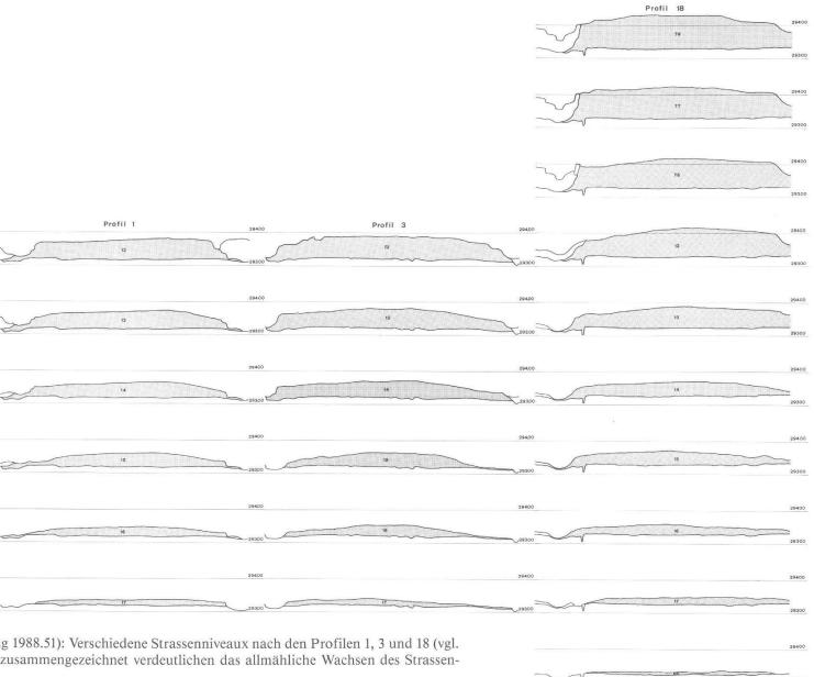
Abb. 12 Augst, Insula 22 (Grabung 1988.51): Verschiedene Strassenniveaux nach den Profilen 1, 3 und 18 (vgl. Abb. 1 und 2) synchron zusammengezeichnet verdeutlichen das allmähliche Wachsen des Strassendammes.
