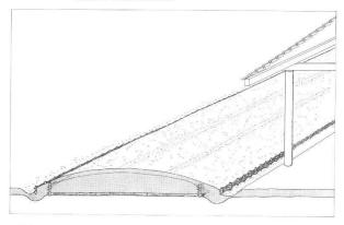
Abb. 21 Darstellungsversuch einer Strassenerneuerung in Augst: Variante Flechtwerk.
