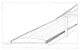
Abb. 20 Strassenaufbau in Augst: Rekonstruktionsversuch mit Prügellager und seitlich stützendem Flechtwerk.
