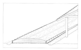
Abb. 19 Strassenaufbau in Augst: Rekonstruktionsversuch mit Prügellager und Pföstchen, die Bohlen gegen Seitendruck stützen.
