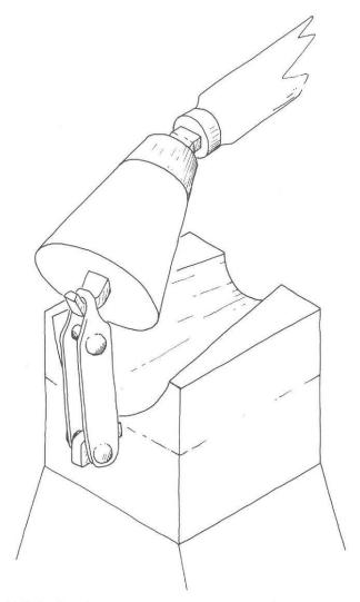
Abb. 4 Blick «in» das rekonstruierte Presswerkzeug. Isometrische Skizze.
