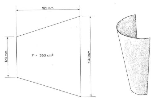
Abb. 3 links: zugeschnittenes Blechtrapez. M. 1:4. rechts: perspektivische Ansicht des gepressten Trapezes.
