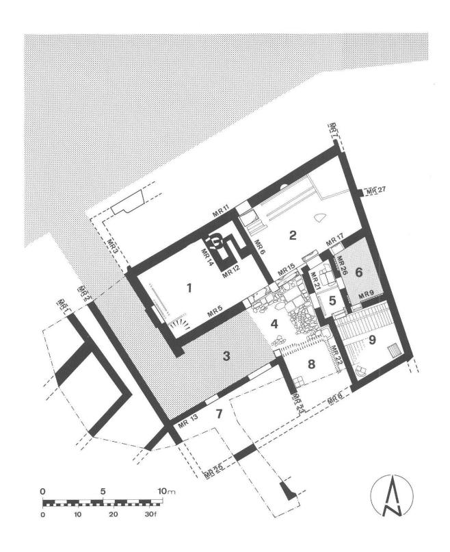
Abb. 2 Kaiseraugst, Parz. 255/257, Schmidmatt. Grundriss M. 1:250. Keller West (1): in der NO-Ecke Räucherkammer, darunter Reste eines Töpferofens; Keller Ost (2): in der NO-Ecke Speisekammer; L-förmige Zufahrtsrampe (3) zum Innenhof (4); Korridor (5) mit Sodbrunnen im N; hypokaustierter Raum (6); Remisenraum (7); Schlachterei (8); Esskammer (9) mit Bretterboden und «Cheminée» in der SW-Ecke.
