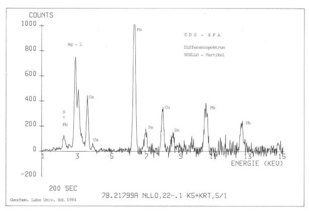
Abb. 5 Energiespektrum eines Niellopartikels. Als chemische Haupt- und Nebenkomponenten sind die Elemente Ag, Pb, Cu, S nachweisbar. Der Befund entspricht der bei «Niello» zu erwartenden chemischen Zusammensetzung.
