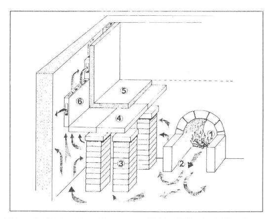
Abb. 1 Schema einer Hypokaustanlage. 1 Feuerungsraum, 2 Heizkanal, 3 Hypokaustpfeiler, 4 Suspensuraplatten (Ziegel oder Naturstein), 5 Fussboden, 6 Wandheizungsziegel (tubuli), s. Anm. 3.
