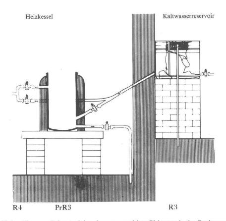
Abb. 6 Schleitheim. Thermen. Rekonstruktion der umgewandelten Bleiwanne in der Zweitverwendung (nach Kretzschmer, vgl. Anm. 4 S. 34 Abb. 59). Süd-Nord-Richtung von links nach rechts. M. ungefähr 1:80.
