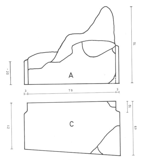
Fig. 7 Avant-bec usé par l'écoulement de l'eau (n° 34).
