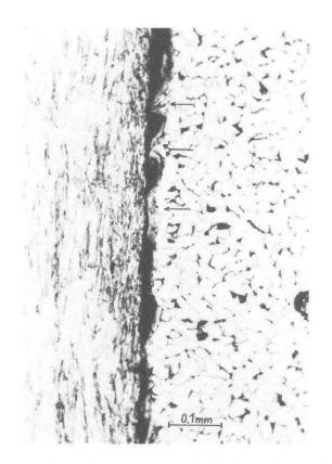
Abb. 13 Stark vergrösserte Partie der Abb. 12 (dortige Lage beim Pfeil, Einsatzzinke 4). Rechts Gefüge des Mittelbleches mit Verformungsstellen (Pfeile) am Sägeschnitt. Links Lineargefüge einer Reparaturzinke.
