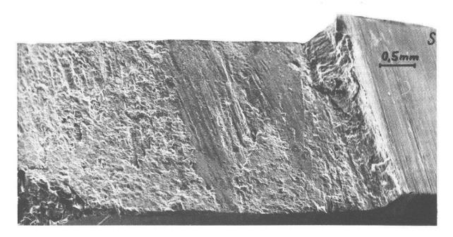
Abb. 14 In römischer Zeit gesägte Reparaturschlitzflanken von der Stelle «R» der Abb. 11. Raster-Elektronenmikroskop-Aufnahme. Die Flächen «S» zeigen die für die Untersuchung von hinten her mittels Diamantscheibe hergestellten Schnittflächen; die Teilfiguren lagen im Kamm auf den beiden Seiten desselben Schlitzes.
