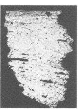
Abb. 4 (oben links). Ausschnitt aus Schliff 3: Querschnitt durch das Mittelblech (vgl. Abb. 8). Obere Schliff-kante = Grenze gegen Schliff 2. Untere Grenze = korrodierte Fläche des Mittelbleches. Schlacken- und Oxideinschlüsse schwarz, zeilenförmig angeordnet. Eisen (Ferrit) hell, lagenweise verschieden grob rekristallisiert.
