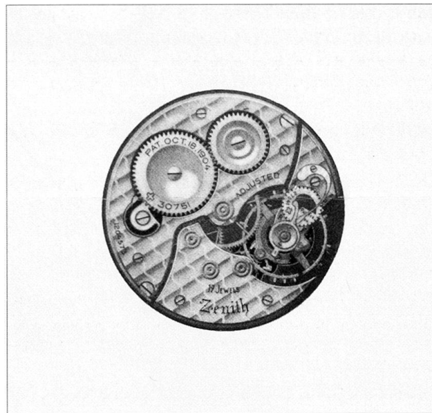
Fig. 4 Rouage d'une montre de poche Zénith: l'entreprise horlogère mécanique produisait elle-même toutes les pièces constituant une montre. Tiré de la même publication que fig. 3.
