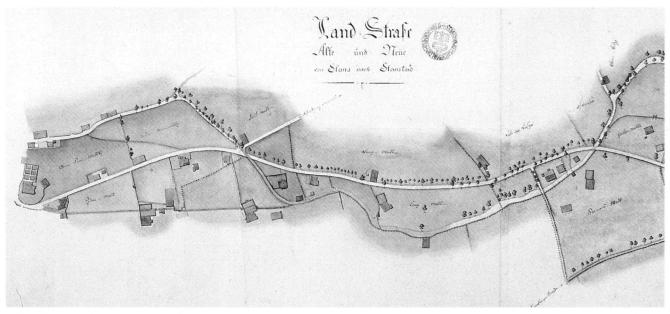
Abb. 102 «Land-Strasse. Alte und Neue von Stans nach Stansstad.» Der sorgfältig kolorierte Plan von Ingenieur Louis von Deschwanden zeigt den alten und den geplanten Verlauf der Verbindungsstrasse von Stans nach Stansstad im Jahr 1837.
