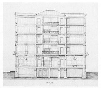
Fig. 23 Ancien Hôtel Bellevue. Confiant envers les propriétés imperméabilisantes de l'asphalte, l'architecte a conçu un splendide cube classique au toit plat. Un vestibule central entouré de galeries permet d'accéder aux chambres (2.6.3). Coupe, Hans Rychner, 1859 (AVN).
