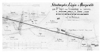
Abb.10 Schwyz, Hauptflecken. Situationsplan der Neubaustrecke Muotathalstrasse (heute Grundstrasse), 5. Projekt 1861. Geradlinige Anlage ohne Berücksichtigung von Topographie und Bausubstanz.
