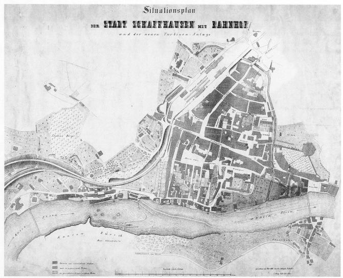
Abb. 29 Situationsplan der Stadt Schaffhausen mit Bahnhof und der neuen Turbinen-Anlage, gezeichnet im Februar 1864 von Adolph Schaber, lithographiert von Gebr. Bäschlin. Farbig eingetragen: die wegen der badischen Bahn (eröffnet 1863) zu erweiternde Bahnhofanlage (links oben), das im Bau begriffene «Wasserwerk» im Rhein mit dem «Moserdamm» (links unten; noch stehen die Zuleitungsdämme der alten Mühlenkanäle) und das Areal des geplanten Industriequartiers am Rhein (rechts).
