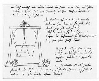
Abb. 12 Zeichnung aus dem «Bautagebuch», das Adolf Schäfer während des Baus des Mädchenschulhauses führte: Hölzerner Kran zum Heben und Transportieren der Sockelsteine.
