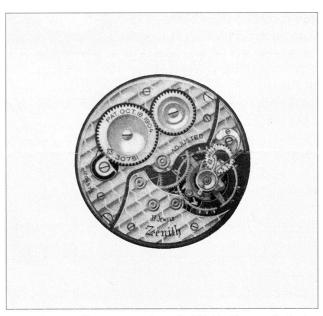
Fig. 4 Rouage d'une montre de poche Zénith: l'entreprise horlogère mécanique produisait elle-même toutes les pièces constituant une montre. Tiré de la même publication que fig. 3.
