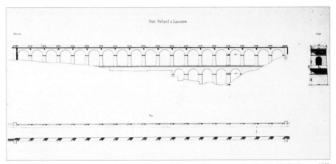
Fig. 38 *Pont Pichard à Lausanne:* élévation, coupe et plan. Détail d'un travail de vacances effectué par Louis Gonin, vers 1852, alors élève à l'Ecole centrale des arts et manufactures à Paris. Encre et aquarelle.
