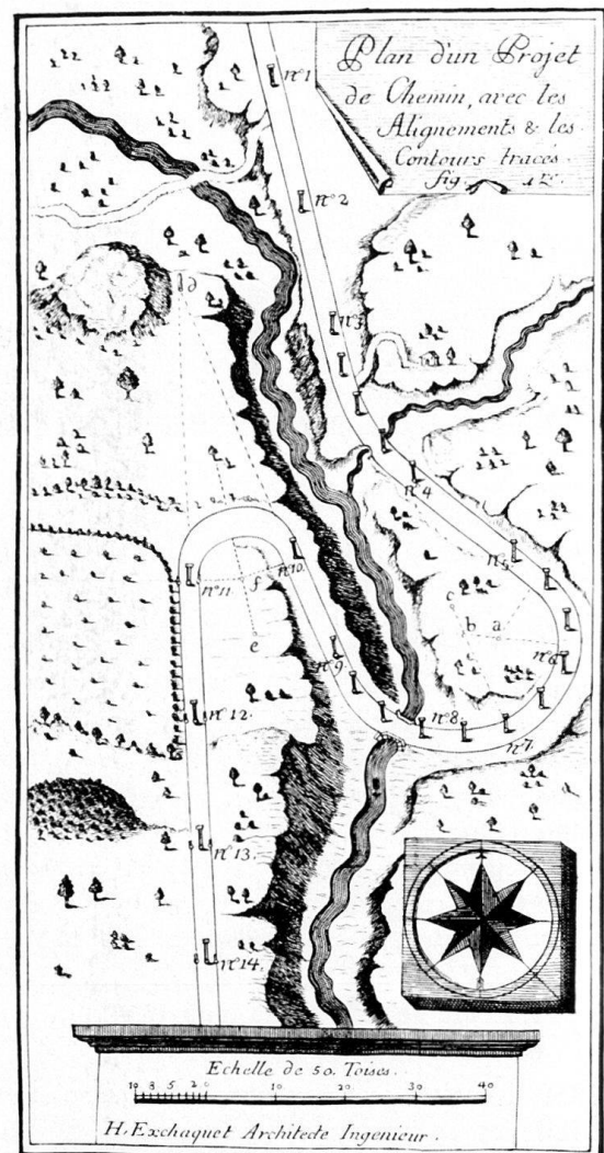
Fig. 34 Plan d'un Projet de Chemin, avec les Alignements & les Contours tracés. Extrait d'A.-H. Exchaquet, Dictionnaire des Ponts & Chaussées , Lausanne, Paris, 1787.
