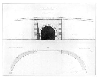
Fig. 37 Tunnel sous la Barre à Lausanne: élévation de la tête orientale et plan. Projet de l'ingénieur cantonal Victor Dériaz, 1851. Encre et aquarelle.
