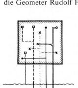
Nun treten die Zuleitungen auf von Gas, Wasser, Elektrizität; die Kanalisation wird eingeführt; das Telephon. Und jede Leitung verzweigt sich im Haus. Dazu kommen noch die von der Strasse unabhängigen Leitungsnetze: die Zentralheizung, die Warmwasseranlage, das Haustelephon — jedes Verbindungsstück, jeder Hahn und Schalter, jeder Wand- und Deckendurchbruch bildet einen Angriffspunkt für die zerstörenden Mächte. Das Haus ist empfindlich geworden; es wird rasch altern.
