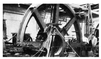
Abb. 34 Baden. Fabrikanlage Brown Boveri & Cie. Auf einer Planscheibe von nur 3 m Durchmesser wird der Rotor eines Wasserkraftgenerators gedreht. Das damals grösste Werkstück wird von den Ingenieuren Sidney William Brown (links) und Walter Boveri (rechts) inspiziert. Photographie 1894.
