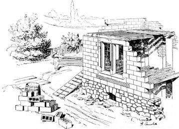
Fig. 39 Genève. Dessin d'Alexandre Camoletti illustrant la mise en œuvre du système Perrier & Saulnier (blocs de ciment armé). Album SIA 1907, p. 104.
