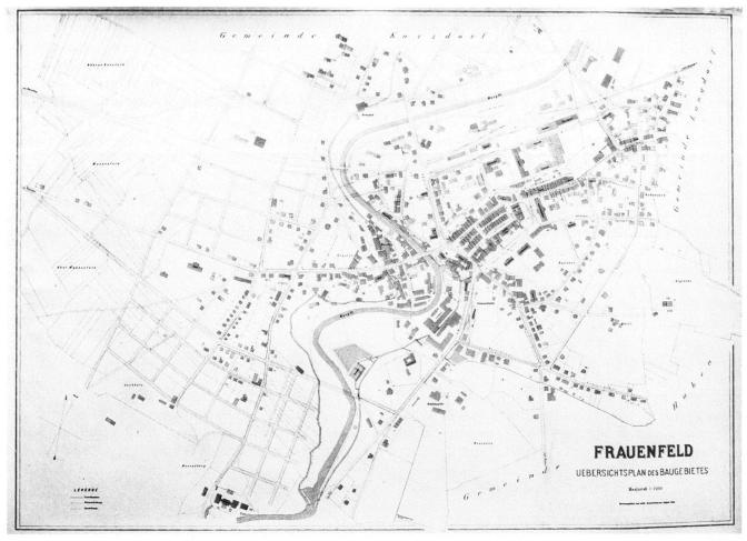
Abb. 27 Frauenfeld. Übersichtsplan des Baugebietes, 1 : 2000, hg. vom Städtischen Geometerbureau, August 1899. Mit Kanalisations-, Wasserleitungs- und Gasleitungsnetz und dem neugeplanten Strassennetz.
