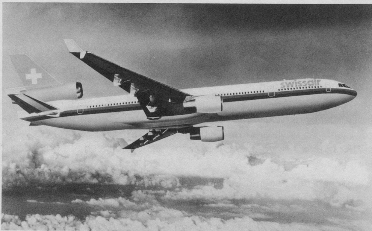
MD-11 , der ab Frühjahr 1990 auf Langstreckenflügen zum Einsatz gelangt. (Passagiere: 22 First / 80 Business / 147 Economy Class, total 249 Passagiere, Reichweite mit voller Passagiernutzlast: rund 12'000 km).
