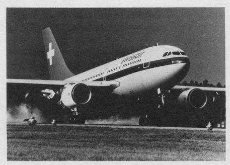
Start nur noch 83 dB (A) im Mittel, was gegenüber der 1960 eingeführten DC-8-30, die 102 dB (A) produziert, eine Reduktion von 19 dB (A) bedeutet. Auch bei den Abgaswerten sind markante Verbesserungen festzustellen.
