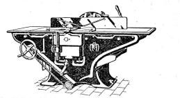
Kombinierte Abricht-, Kehl- und Dickenhobelmaschine Mod. H. D. — 360, 450, 530 und 610 mm Hobelbreite
