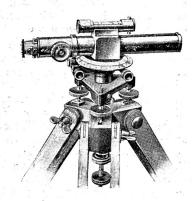
latte bis 200 m Entfernung. Wie aus der Abbildung ersichtlich, besitt dieses Instrument außerdem noch einen Horizontalkreis je nach Wunsch in 360° oder 400° geteilt, sodaß jeder x-beliebige Winkel abgesteckt werden kann, ein Vorteil, der jedem Baufachmann sofort einleuchtet.
