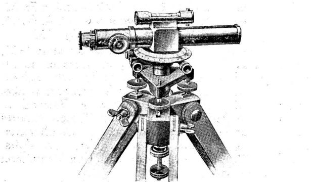
latte bis 200 m Entfernung. Wie aus der Abbildung ersichtlich, besitzt dieses Instrument außerdem noch einen Horizontalkreis je nach Wunsch in  $360^\circ$  oder  $400^\circ$  geteilt, sodaß jeder x-beliebige Winkel abgesteckt werden kann, ein Vorteil, der jedem Baufachmann sofort einleuchtet.
