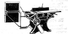
Mod. H. D. L. KOMBINIERTE HOBELMASCHINE -410, 510, 610 mm Hobelbreite
