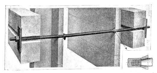
Fig. 1. Dübelschraube
