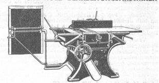
KOMBINIERTE HOBELMASCHINE -Mod. H. D. L. 410, 510, 610 mm Hobelbreite
