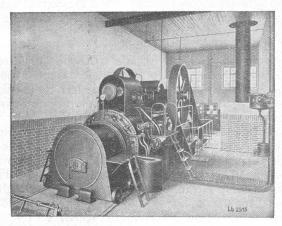
Gegendrucklokomobile mit Abdampfverwertung und Treppenrost-Vorfeuerung für Sägemehl.
