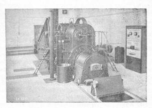
Verbund Lokomobile mit Kondensation und Treppenrost-Vorfeuerung für Sägemehl.
