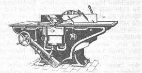
Kombinierte Abricht-, Kehl- und Dickenhobelmaschine Mod. H. D. — 360, 450, 530 und 610 mm Hobelbreite
