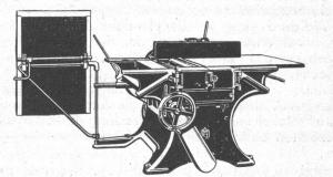
KOMBINIERTE HOBELMASCHINE — Mod. H. D. L. 410, 510, 610 mm Hobelbreite 8c
