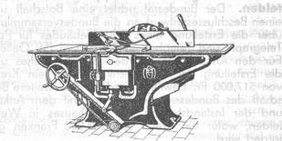
Kombinierte Abricht-, Kehl- und Dickenhobelmaschine Mod. H. D. — 360, 450, 530 und 610 mm Hobelbreite
