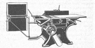
KOMBINIERTE HOBELMASCHINE — Mod. H. D. L. 410, 510, 610 mm Hobelbreite 22 3
