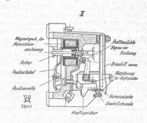
Besonders zu erwähnen sind die in jedem Pol angeordneten Kraftspeicher. Dies sind Zwischenglieder, die die Auslöserelais nicht direkt auf die Auslösewelle wirken lassen. Dadurch wird eine gegenseitige Beeinflussung der Relais vermieden, d. h. die Relais brauchen sich nicht mehr anzustrengen, wenn nur ein einzelnes anspricht, als wenn mehrere bei der Auslösung beteiligt sind. Es ist auch gleichgültig, ob der Kontaktdruck groß oder klein ist. Die Auslösegenauigkeit wird dadurch wesentlich erhöht.
