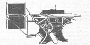
KOMBINIERTE HOBELMASCHINE — Mod. H. D. L. 410, 510, 610 mm Hobelbreite 22 3
