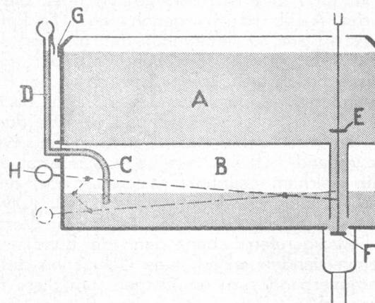
mer in die eine oder andere Endstellung schnappt. Wird nun das Einlaufventil „E“ geschlossen, so öffnet sich im gleichen Moment das Auslaufventil „F“ und der abgemessene Inhalt der Kammer „B“ entleert sich durch das Abflussrohr in die Mischtrömmel. Darauf wird der Betätigungshebel „H“ wieder umgestellt und das Spiel beginnt von neuem.
