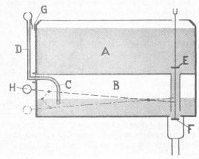
mer in die eine oder andere Endstellung schnappt. Wird nun das Einlaßventil "E" geschlossen, so öffnet sich im gleichen Moment das Auslaufventil "F" und der abgemessene Inhalt der Kammer "B" entleert sich durch das Abflußrohr in die Mischtrommel. Darauf wird der Betätigungshebel "H" wieder umge-
