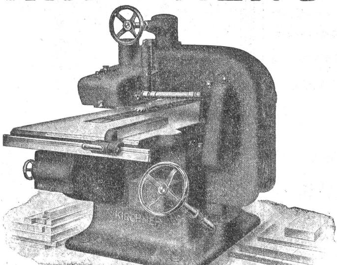
LAD. Autom. Hochleistungs- Elektro-, Besäum- und Zuschneide-Kreissäge
