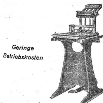
Kisten-Nagelmaschine mit Fußbetrieb für Zigarren-Kisten usw.
