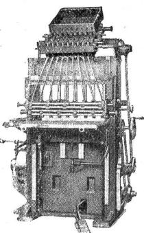
Kisten-Nagelmaschine „Triumpf“ Zickzacknagelung,
