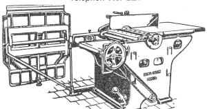
AHL: Kombinierte Abricht-Dickenhobelmaschine
