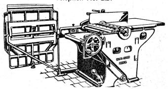
AHL: Kombinierte Abricht-Dickenhobelmaschine
