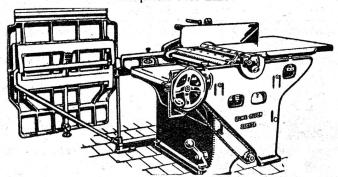
AHL: Kombinierte Abricht-Dickenhobelmaschine
