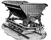
Wir liefern Rollwagen in jeder Größe u. Ausführung nach Wunsch mit Stahlgußrollen von 74, 80 und 90 mm Breite, Rollenlager mit und ohne Rollenkorb, automatischen Muldenfeststeller, mit und ohne Bockstützen
