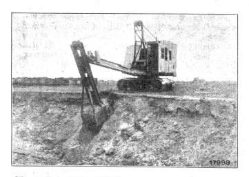
Abb. 2. Universal-Diesel-Löffelbagger als Tieflöffelbagger.
