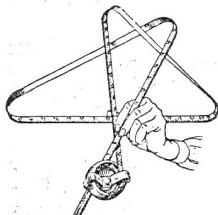
Das „Centima“-Stahlmaßband ist durch einen Druck meßbereit steht gerade auf 2 m Länge, ermöglicht Meßungen über Rundungen und in Winkeln und kann in der Westentasche nachgetragen werden. Preis Fr. 7.50 franko gegen Nachnahme oder Voreinsendung.
